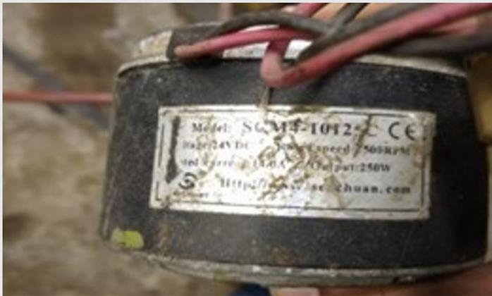
Figura 8. Motor eléctrico de 24 volts, 250 watts.
