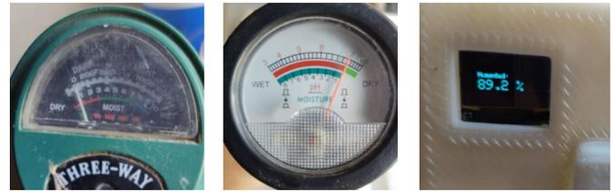
Figura 8. Pantallas de visualización de datos del dispositivo desarrollado, OEM® y Nahita® respectivamente.
