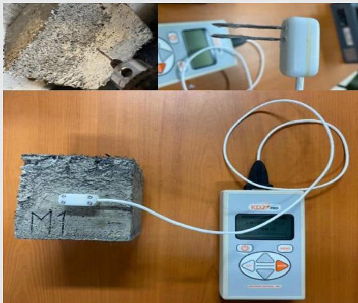
Figura 3. Proceso para medición con el instrumento KD2 PRO.
