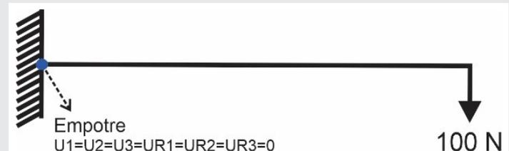
Figura 8.- Condiciones de frontera considerando elementos tipo "3D"
