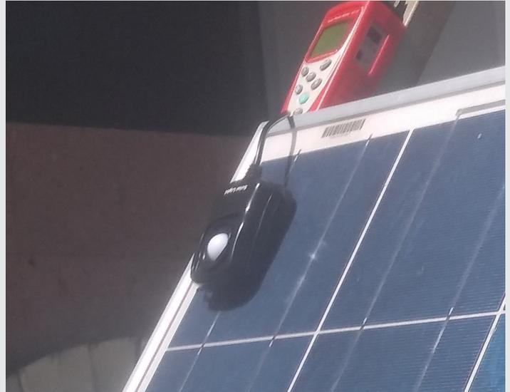
Figura 1. Imagen del panel solar Eco Green modelo EGP-40P-36 y el medidor solar Anaheim Scientific H117, en la esquina superior izquierda.
