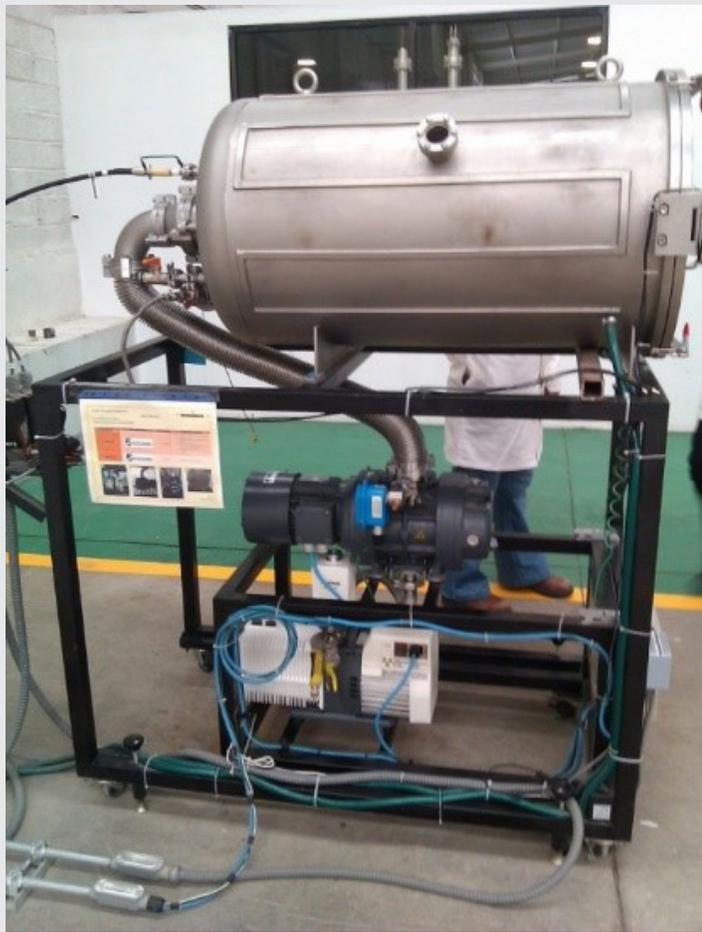
Figura 1. Reactor para nitruración iónica.
