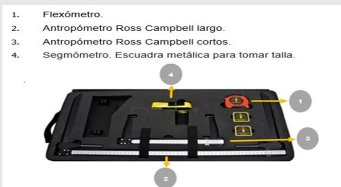
Figura 2. Instrumentos utilizados para la toma de mediciones antropométricas.
