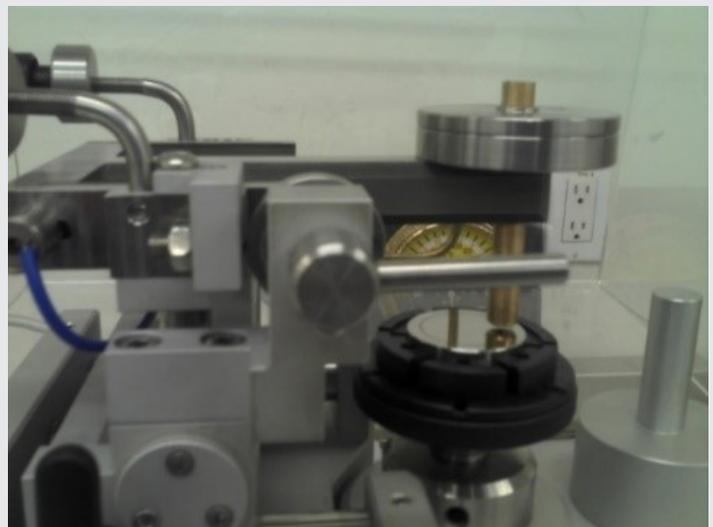
Figura 2. Tribómetro de prueba tipo pin-on.
