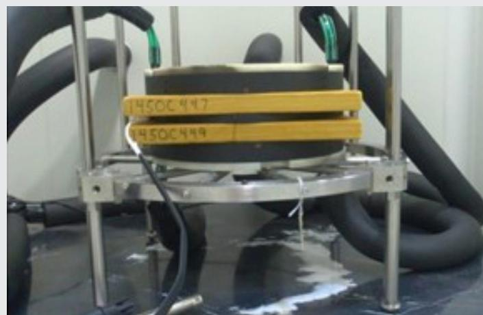
Figura 3. Aparato de Placa Caliente con Guarda (APCG).
