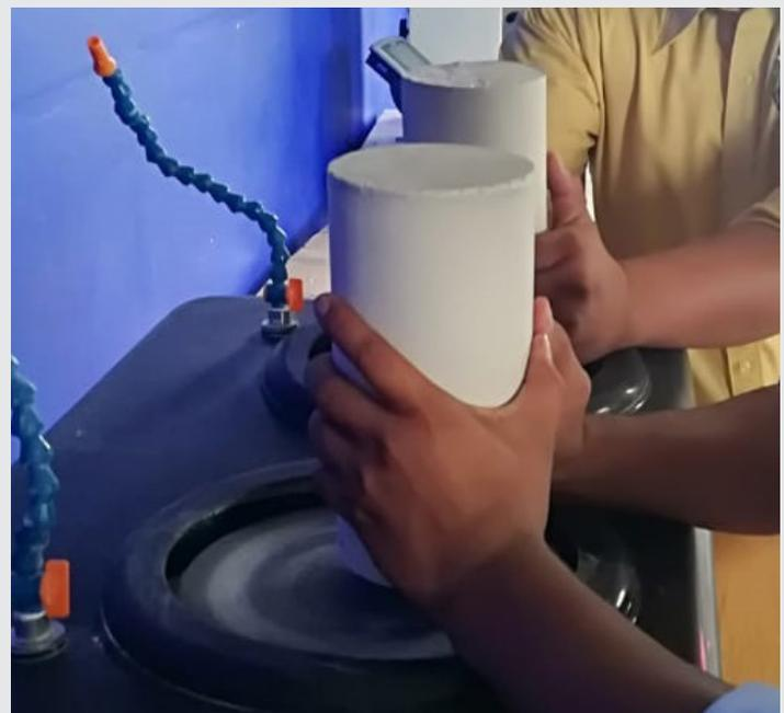
Figura 7. Lijado de las caras de las probetas:
