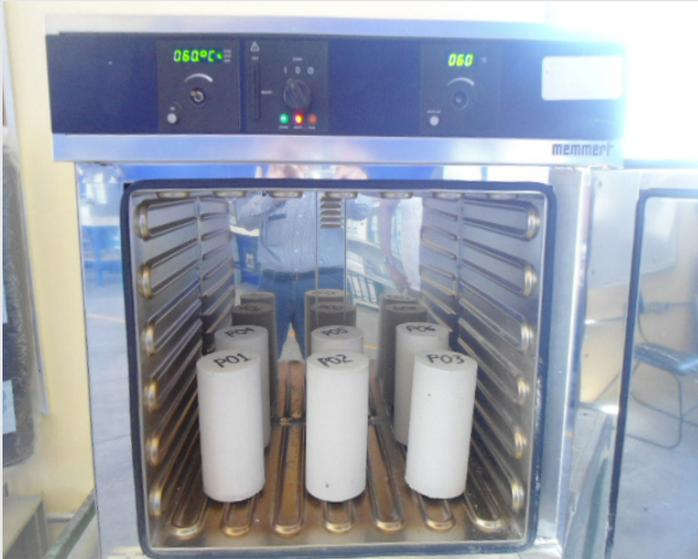
Figura 9. Secado de las probetas cilíndricas:
