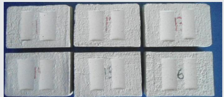
Figura 17. Probetas después del ensayo de abrasión.
