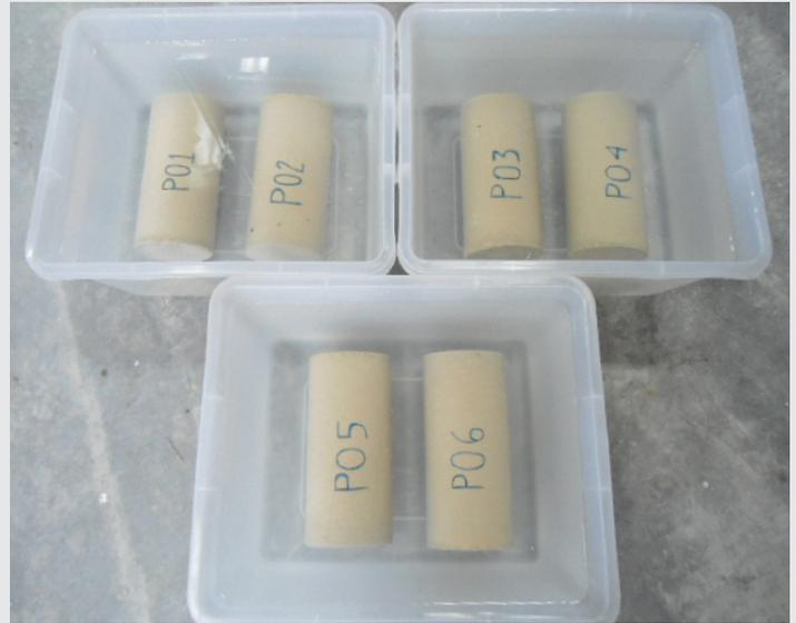
Figura 11. Probetas sumergidas en agua potable.
