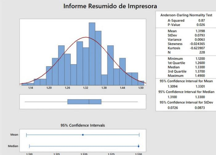
Figura 3. Análisis estadístico de los tiempos de la máquina impresora
