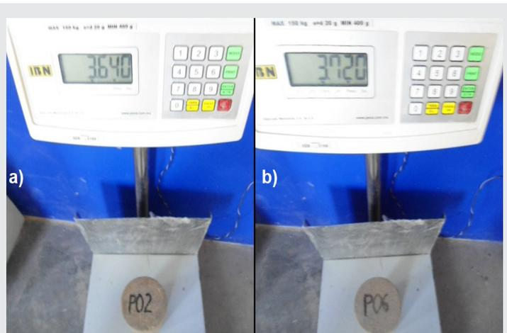
Figura 12. Peso saturado de las probetas cilíndricas:
