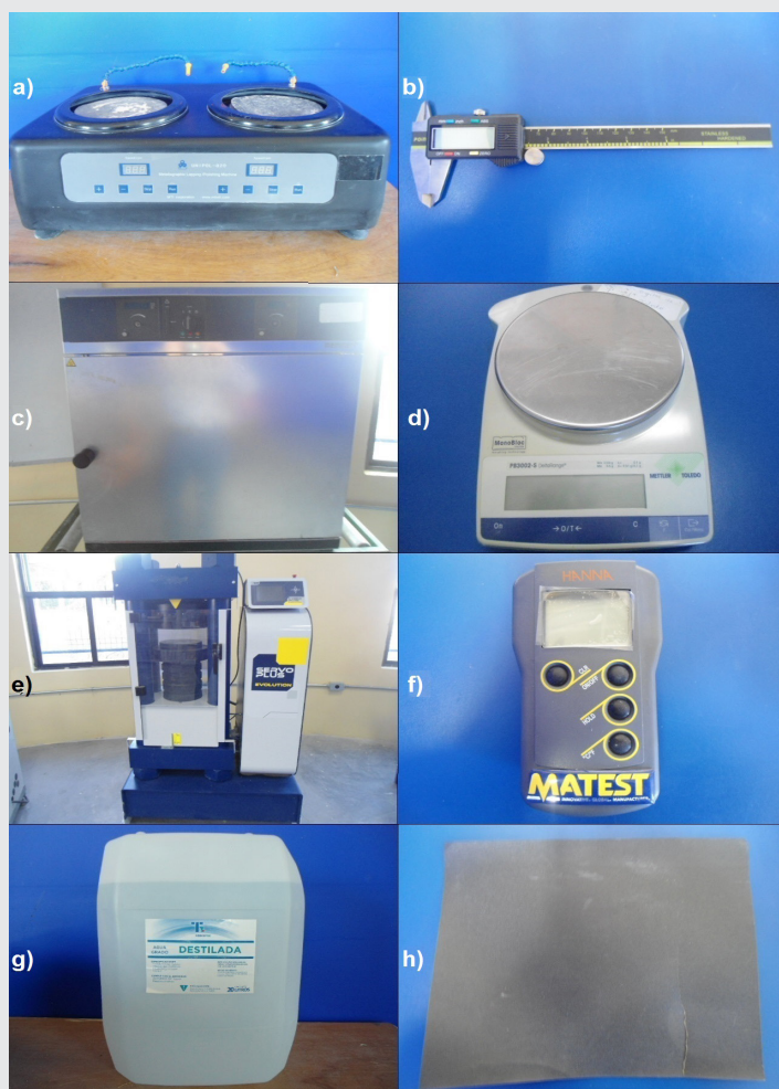
Figura 3. a) Pulidora; b) Vernier digital; c) Horno de secado; d) Báscula digital; e) Máquina de compresión; f) Termómetro digital; g) Agua destilada; h) Lijas con tamaño de grano 400.
