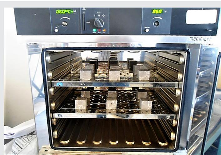
Figura 5. Secado inicial de las probetas.
