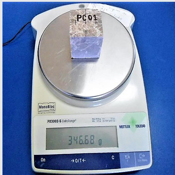
Figura 6. Peso seco inicial de la probeta PC01.
