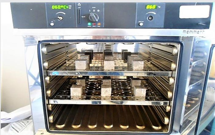
Figura 12. Secado final de las probetas.
