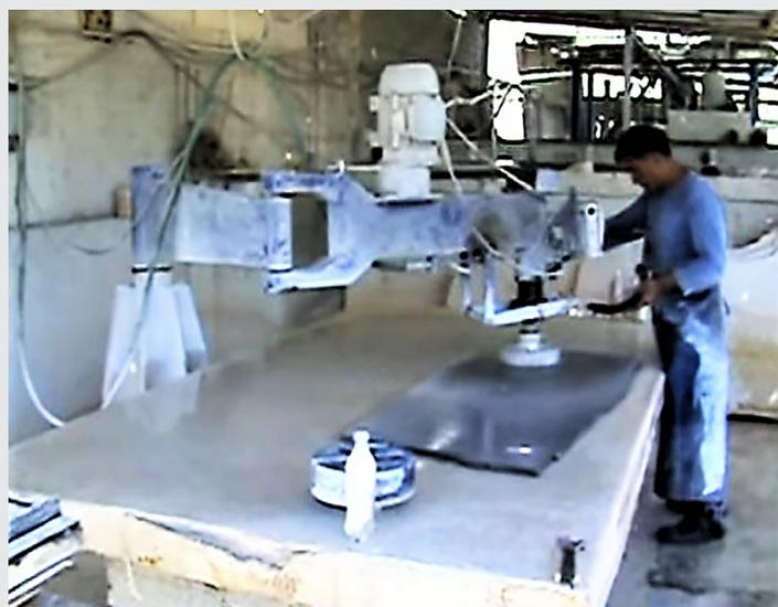
Figura 3. Fotografía de la pulidora de brazo convencional
