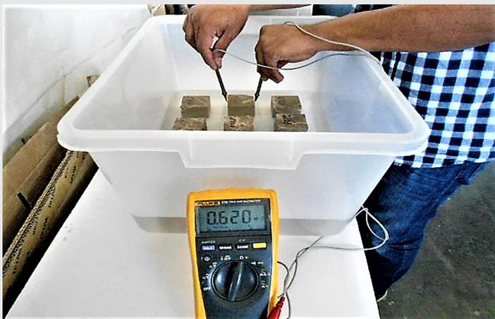
Figura 11. Medición de la resistividad.
