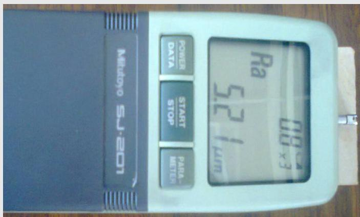
Figura 6. Fotografía de la rugosidad inicial de probeta.
