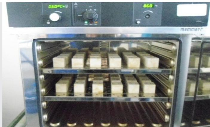
Figura 5. Fotografía del secado de las 48 probetas.
