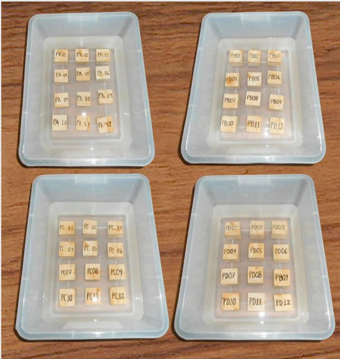
Figura 7. Fotografías de la inmersión de las 48 probetas.
