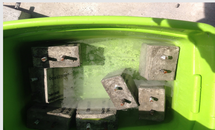
Figura 2.4. Vigas de concreto en experimentación y curado.
