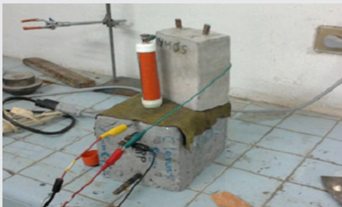
Figura 2.5. Medición de potenciales de corrosión.
