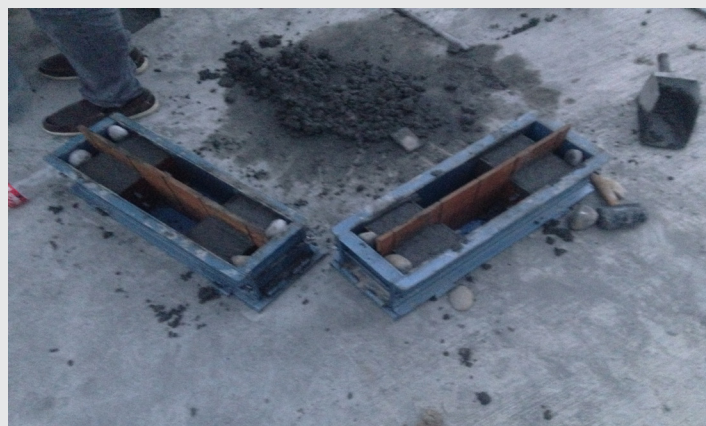
Figura 2.3. Elaboración de vigas de concreto reforzado.
