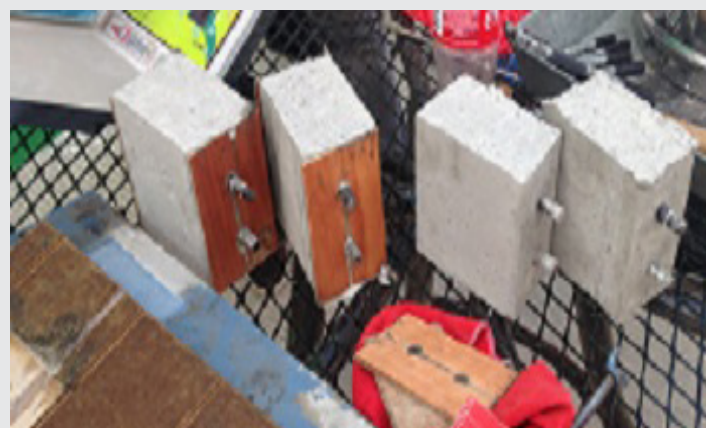
Figura 2.3.1. Descimbrado y colocación de curado de los especímenes de concreto.
