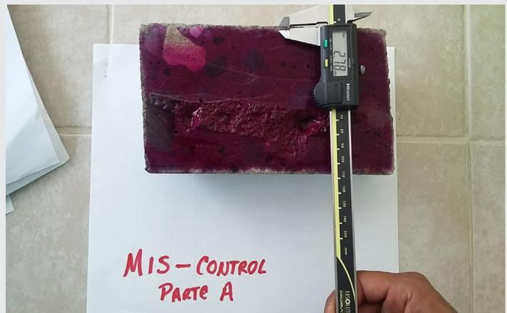
Imagen 3.1. Coloración de carbonatación en mezcla de control de Misantla mes de enero 2016.
