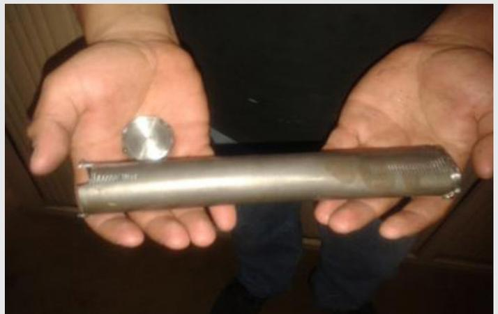
Fig. 2 Extremos aplastados por la máquina de tensión
