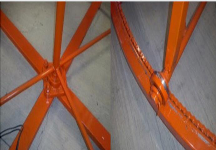
Figura 10. Eje vertical que soporta al mecanismo
