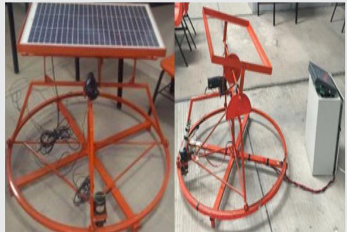
Figura 12: Diseño del prototipo final, a) Estructura mecánica, b) funcionamiento del sistema de control con PLC
