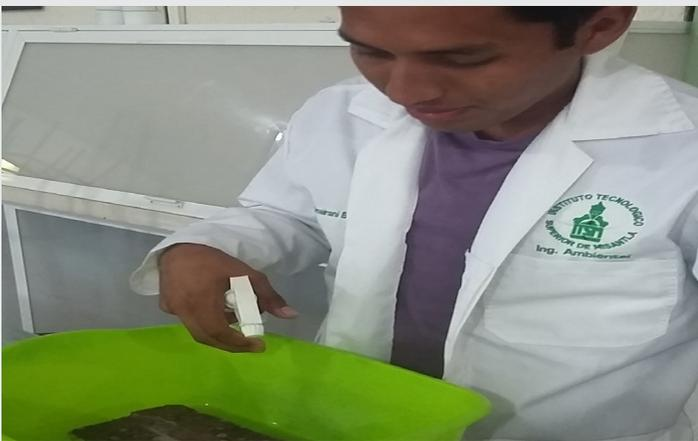
Imagen 2.13. Colocación de la solución de Fenolftaleína siendo rociada con aspersor.
