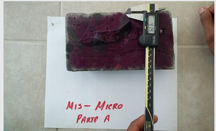
Imagen 3.4. Prueba de carbonatación en mezcla con Microsilice de Misantla mes de enero.
