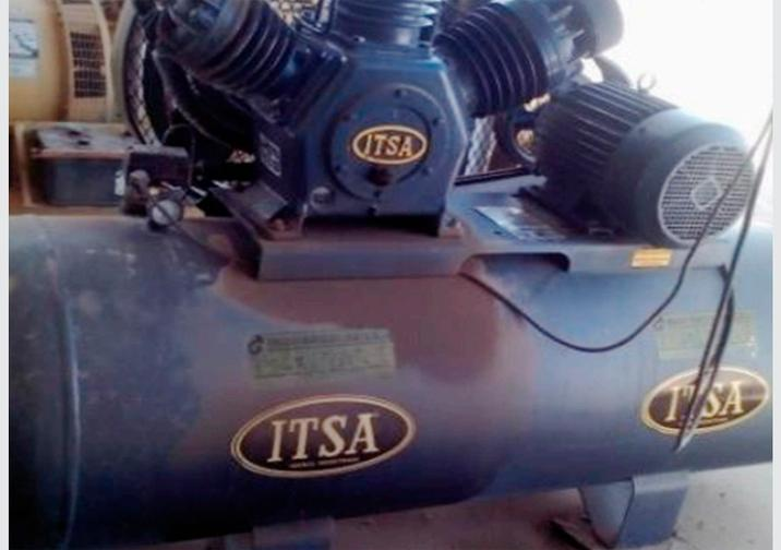
Fig.13. Compresor de 10 HP
