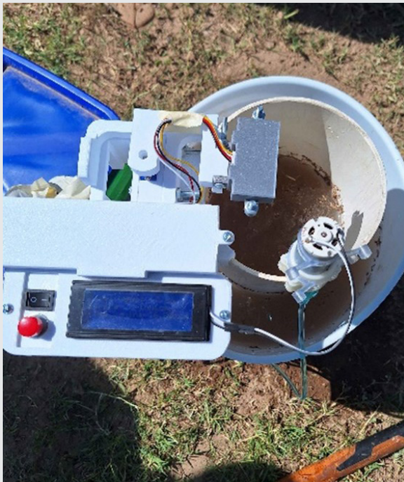
Figura 9. Infiltrómetro del sitio C con sistema de bombeo. Fuente: Elaboración propia.
