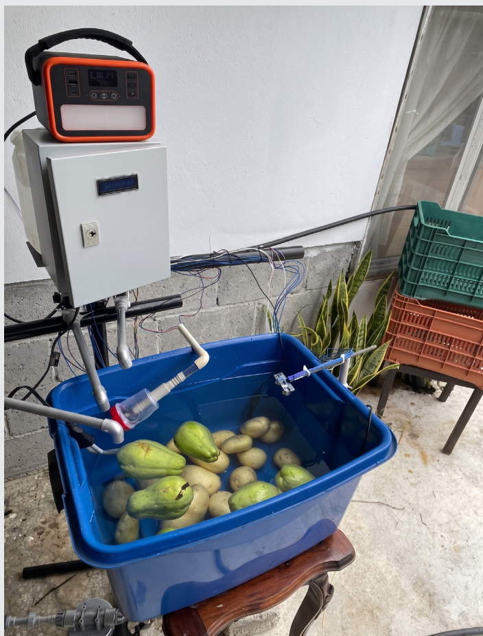
Figura 14. Sistema de Desinfección de frutas y hortalizas. Fuente: Imagen propia.
