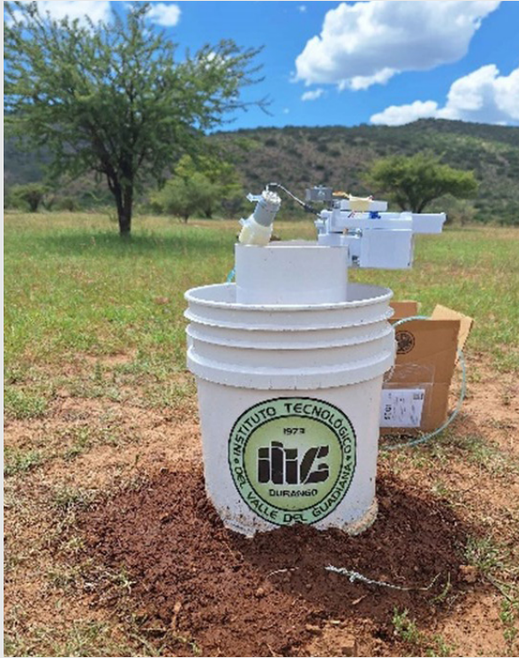
Figura 8. Instalación de infiltrómetros. Fuente: Elaboración propia.
