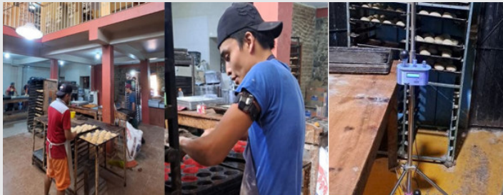
Figura 1. documentación de las áreas de amasado, medición ambiental y fisiológica; mediante el uso del medidor de estrés térmico y el brazalete biométrico.
