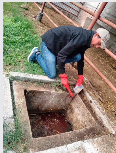
Figura 3. Toma manual de sólidos gruesos en la caja de registro durante la caracterización hidráulica.
