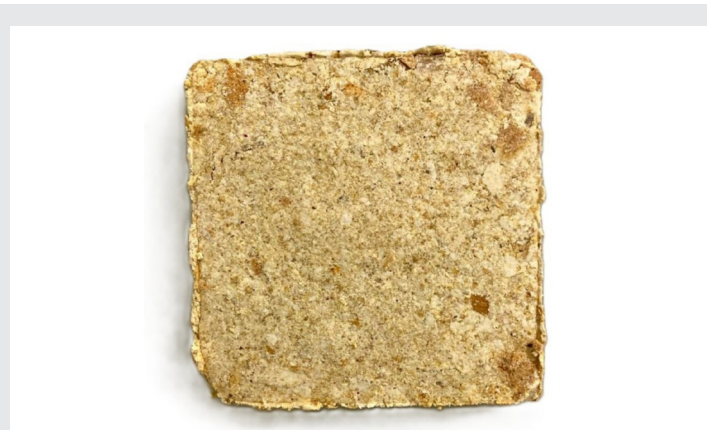
Figura 6. Prototipo de esponja elaborada a partir de las cáscaras de naranja secas.
