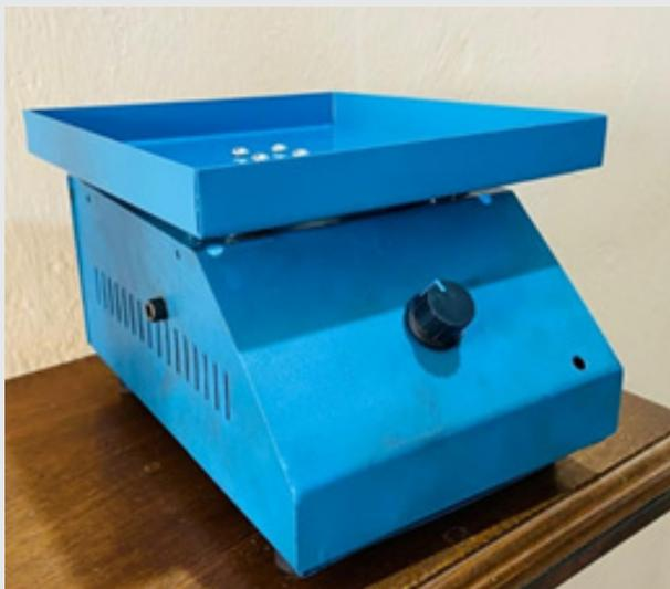
Figura 13. Agitador orbital.
