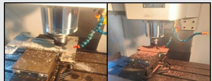
Figura 6. Maquinado de probetas.
