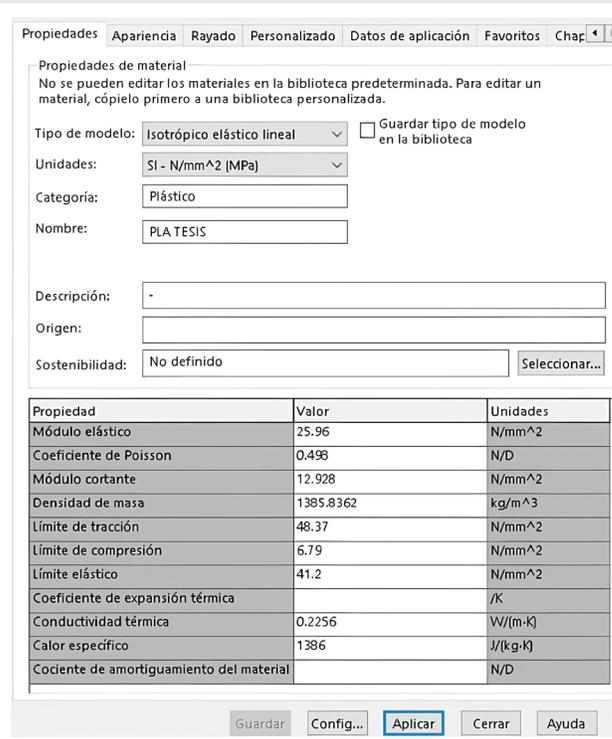
Figura 7. Configuración de los parámetros del filamento PLA en el software utilizado para el ensayo de esfuerzos.
