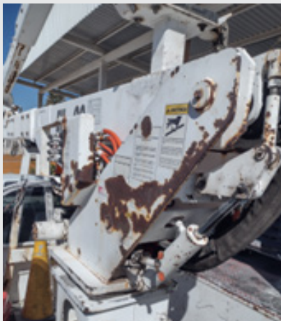
Figura 3. Brazo metálico presentando herrumbre en su estructura. Fuente: Elaboración propia.
