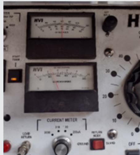
Figura 7. Inyección de voltaje y corriente de fuga durante la prueba dieléctrica a un equipo hidráulico de canastilla sencilla. Fuente: Elaboración propia.
