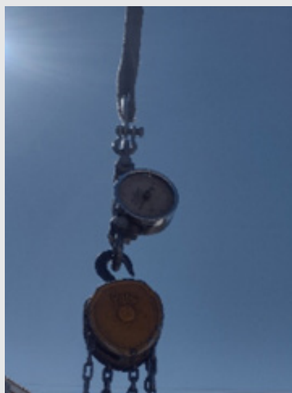
Figura 10. Aplicación de la carga generando un esfuerzo al equipo para ensayo de emisión acústica. Fuente: Elaboración propia.
