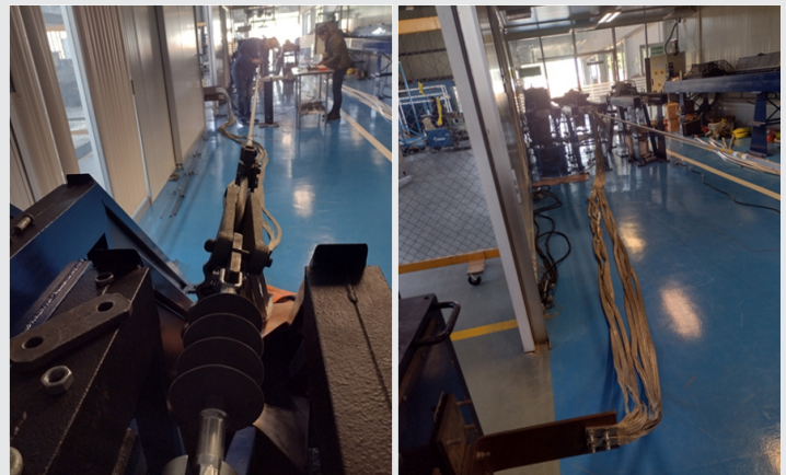
Figura 6. Arreglo de prueba para esfuerzos térmicos. Fuente: Elaboración propia.
