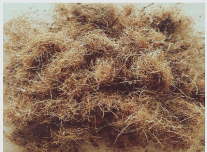
Figura 3. Fibras extraídas de estopa de coco.
