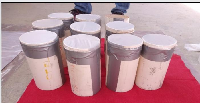
Figura 5. Moldes de PVC utilizados para el colado de especímenes con dimensiones de 10 x 20 cm.
