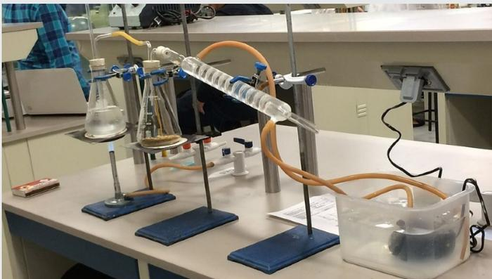
Figura 1. Condensador para extracción de esencias.
