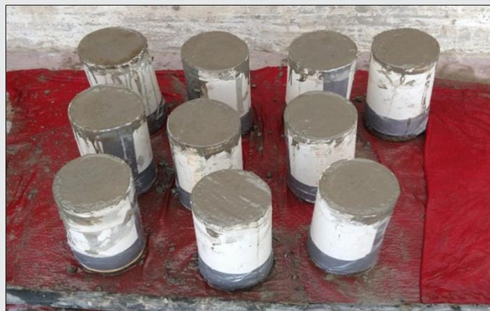
Figura 6. Colado de especímenes de concreto.
