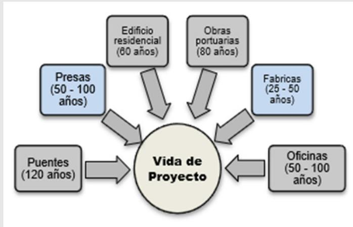
Figura 2. Vida de proyecto considerado para diferentes tipos de estructuras.
