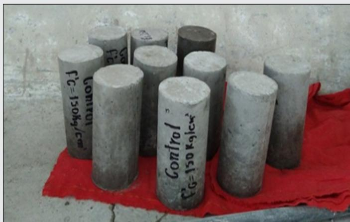
Figura 7. Descimbrado de cilindros de concreto.
