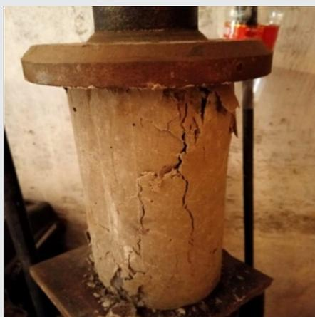
Figura 9. Ensayo de compresión de los especímenes de concreto.
