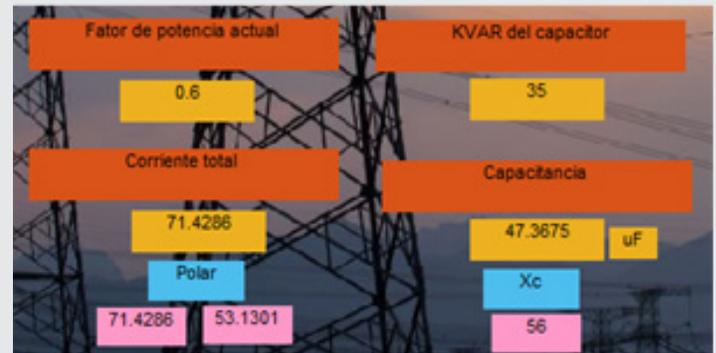
Figura 6. Sección de datos FP actual, corriente, KVAR a inyectar y capacitancia.
