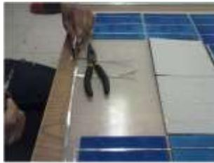
Figura 7. Unión de celdas
