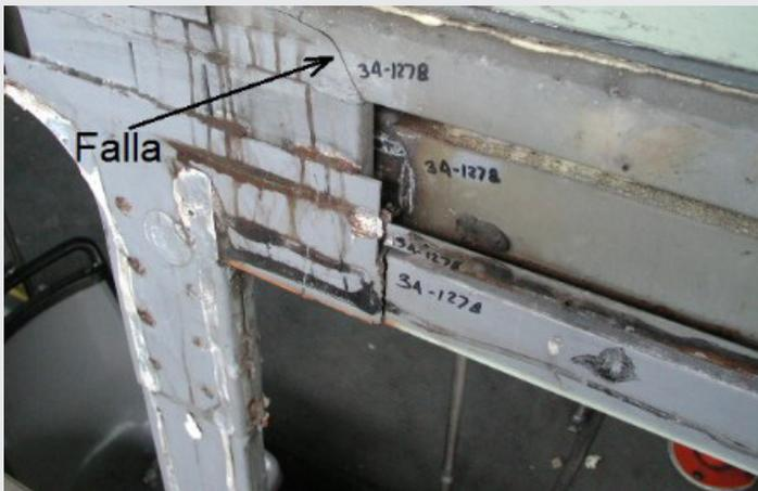
Figura 3. Falla en la estructura del autobús.
