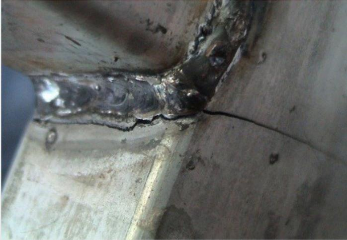
Figura 7. Grieta resultante del ensayo de fatiga.
