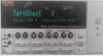
Figura 2. Panel frontal del electrómetro Keithley 6517B.
