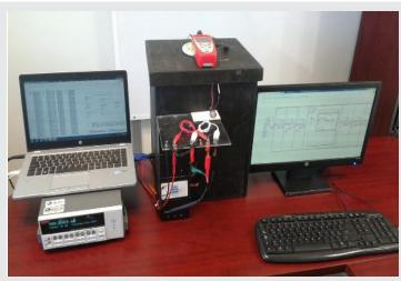
Figura 11. Sistema trazador y de análisis de curvas VI.
