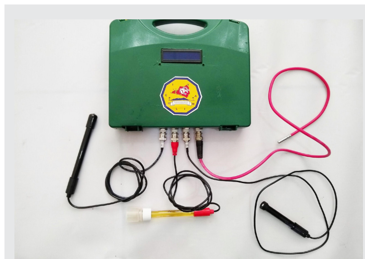
Figura 2. Dispositivo portátil para el monitoreo de la calidad del agua - Vista Exterior.
