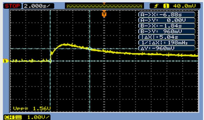
Figura 7. Oscilograma de la señal v\_o a la salida del acondicionador de la señal del potenciómetro.
