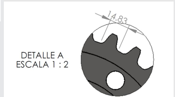
Figura 6. Engrane de dientes rectos hecho en Solidwork 2015 ° Vista de Detalle
