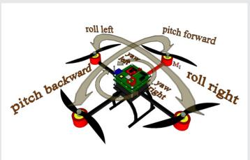
Figura 4. Torques en roll, pitch y yaw en un cuadricóptero. (Carrillo et al., 2013).
