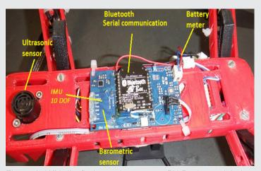
Figura 8. UAV diseñado por la empresa PH Devices, vista trasera
