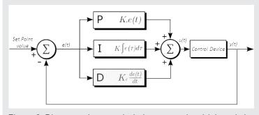
Figura 6. Diagrama de un controlador proporcional-integral-derivativo.
