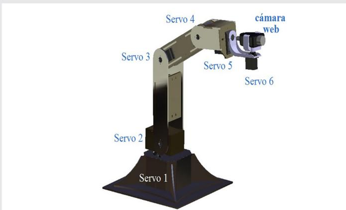
Figura 1. Modelo CAD del brazo robot de 6 GDL.
