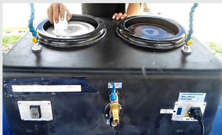
Figura 2. Lijado y pulido de las probetas.
