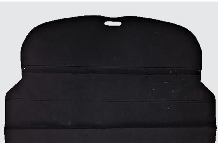
Figura 1. Forro de lona para la cubierta retráctil portaequipaje.
