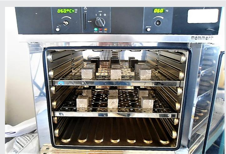
Figura 5. Secado inicial de las probetas.
