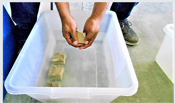
Figura 10. Lavado superficial de probetas.
