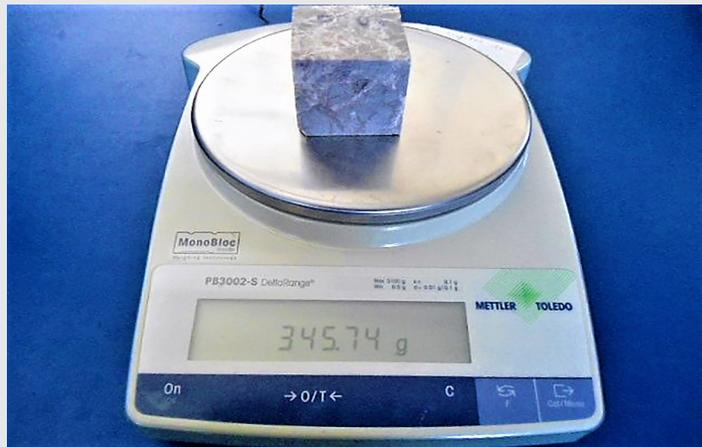
Figura 13. Peso seco final de la probeta PC01.
