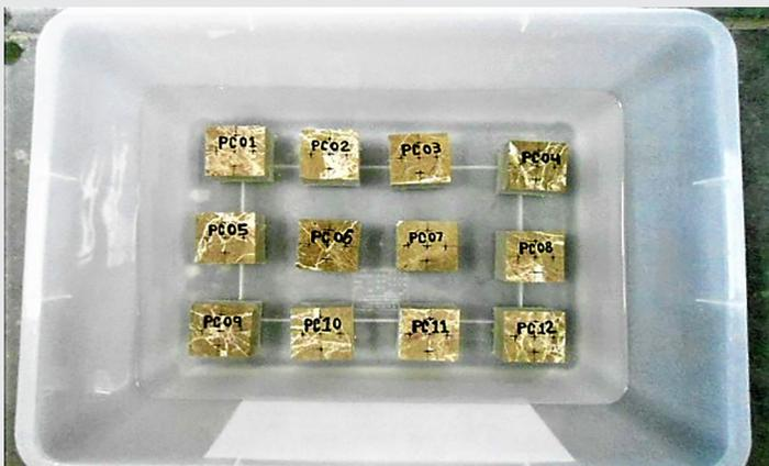
Figura 8. Probetas en cloruro de sodio al 16%.
