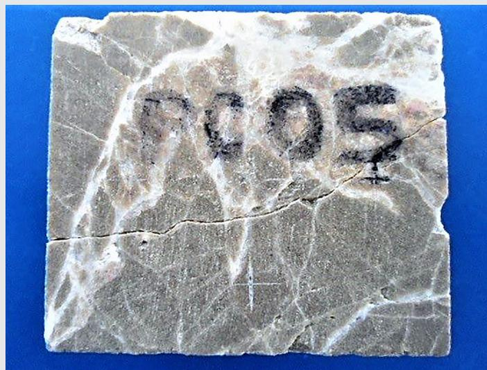
Figura 16. Probeta PC05 con grietas superficiales.
