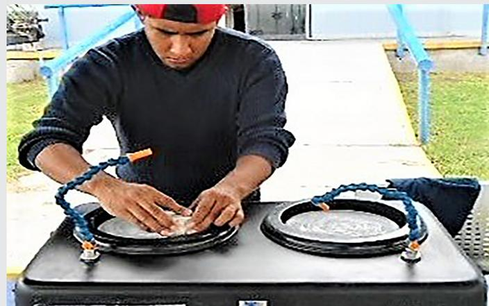
Figura 3. Lijado y pulido de las probetas.
