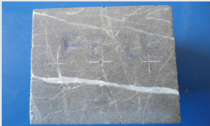
Figura 12. Fotografía de una probeta con grietas.
