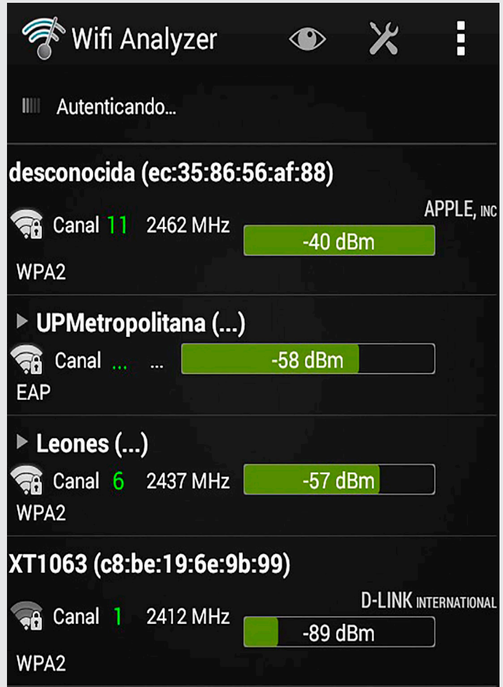
Figura 2. Aplicación WiFi Analyzer reporta el valor de RSSI en dBm de los APs cercanos.
