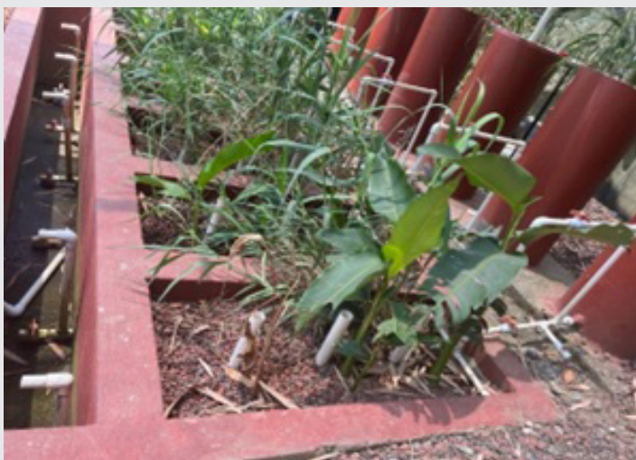
Figura 2 Densidad vegetativa de los humedales construidos es un factor en la precisión de la fotogrametría.
