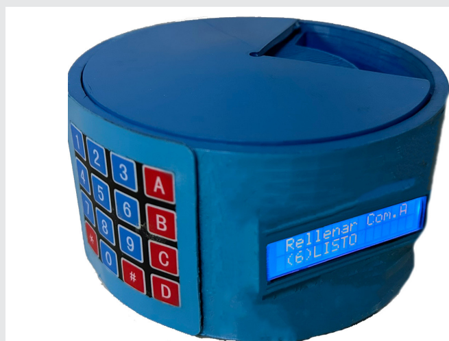
Figura 11. Dispositivo físicamente construido durante el proceso de rellenar compartimentos. Fuente: Elaboración propia.
