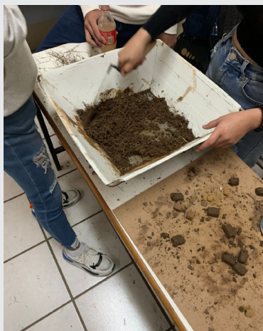
Figura 4. Preparación de la mezcla usando ochochal.
