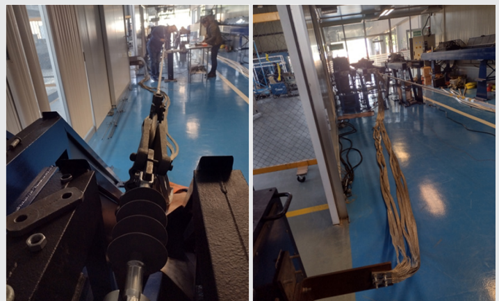
Figura 6. Arreglo de prueba para esfuerzos térmicos.
