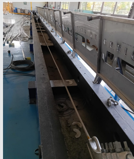
Figura 8. Perspectiva del tendido de la LTs en laboratorio para la prueba de TRN. Fuente: Elaboración propia.
