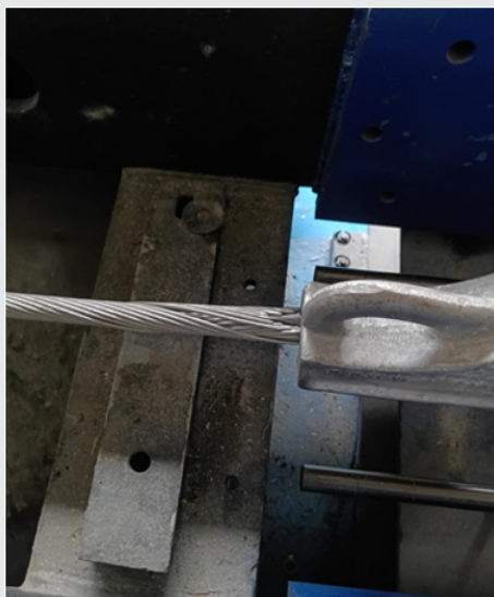
Figura 9. Zona de fractura del OBP.
