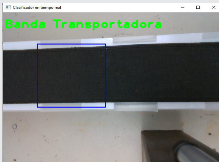
Figura 10. Detección de banda transportadora sin piezas. Fuente: Elaboración propia.
