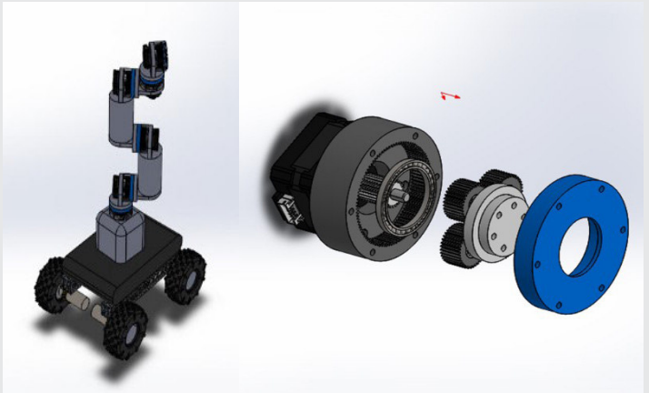
Figura 14. Modelo CAD del robot colaborativo en SolidWorks con engranajes planetarios en las articulaciones.
