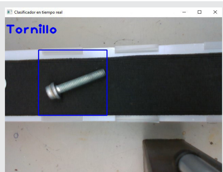
Figura 12. Detección de un tornillo sobre la banda transportadora. Fuente: Elaboración propia.
