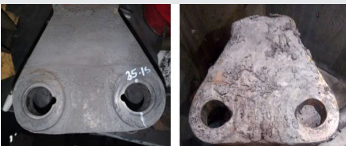
Figura 3. Sillas deformadas en el área del eje.
