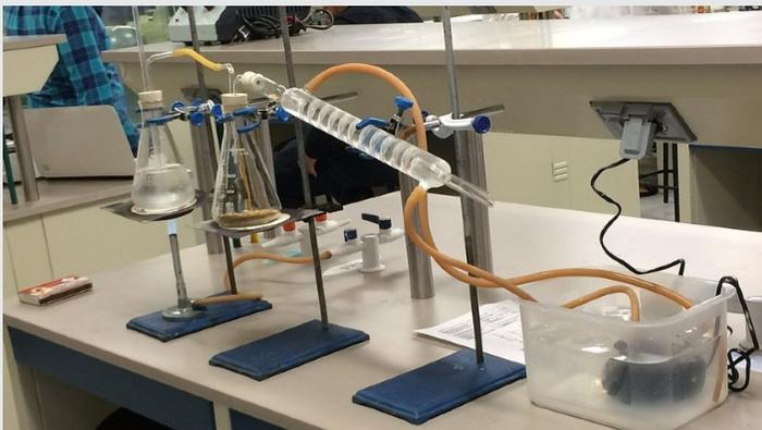
Figura 1. Condensador para extracción de esencias.
