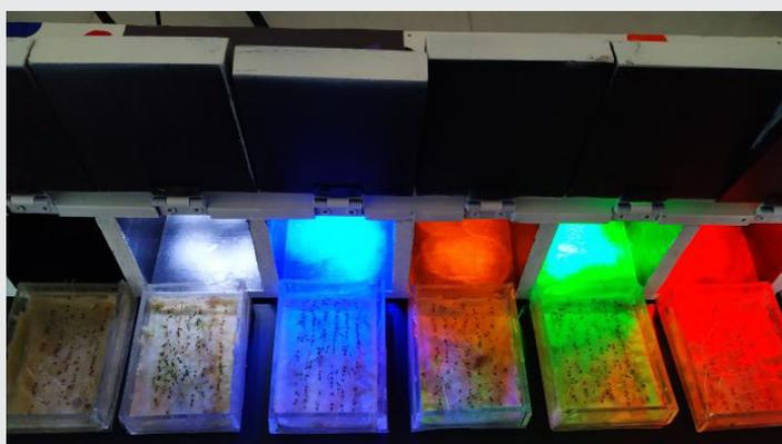
Figura 3. Fotogerminador al día 3 posterior a la siembra. Se presentan los recipientes de acrílico fuera de cada compartimiento, con las semillas de prueba germinadas para cada longitud de onda irradiado, así como los controles positivos (luz blanca) y negativo (obscuridad).
