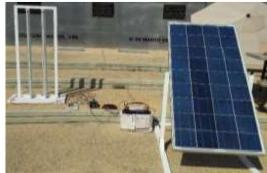
*Fig. 19 Montaje del sistema aislado para la Automatización de la Planta Desaladora*
