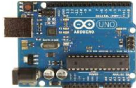
Fig. 15 Arduino UNO R3 empleado para el sistema de control para Automatización la planta.
