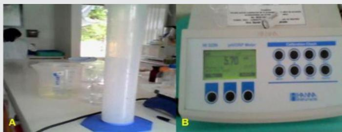
Figuras 10 y 11. Probeta de 2000 mL y potenciómetro
