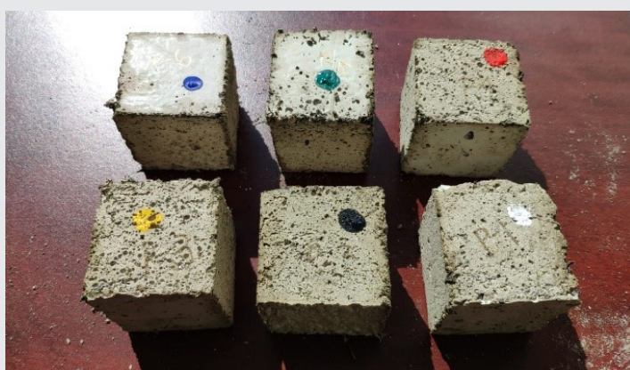
Figura 12. Probetas sin molde después de haber alcanzado sus 28 días de secado.
