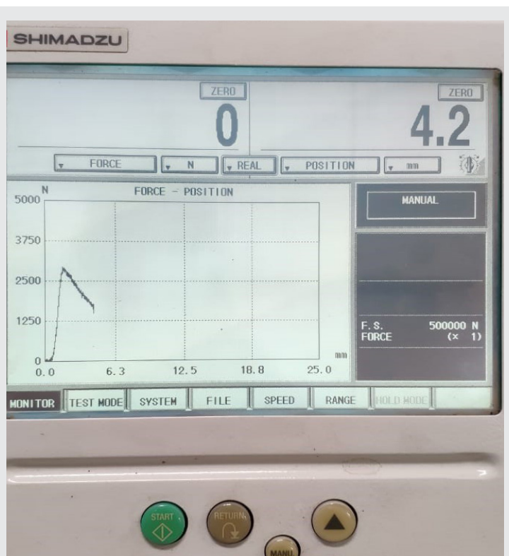
Figura 14. Diagrama de esfuerzo de deformación, se indica la falla cuando la línea va en declive (probeta 6).
