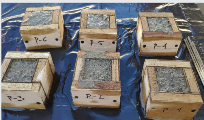
Figura 10. Vaciado de mezcla en moldes de madera.
