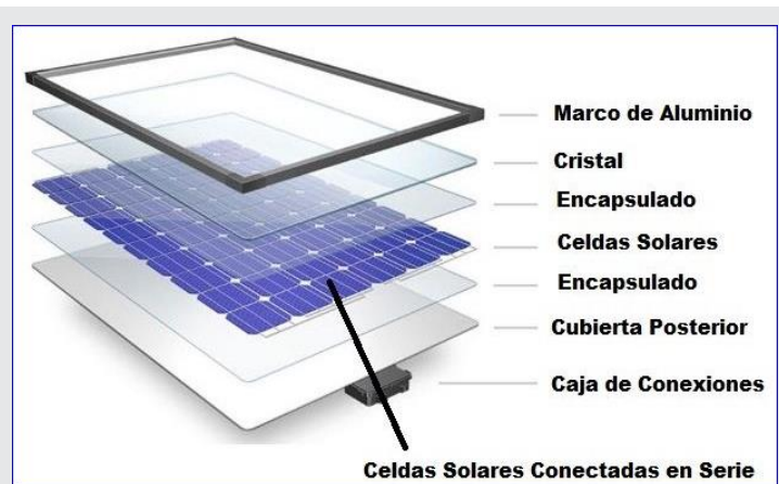
Figura 1. Elementos de un Panel Fotovoltaico.
