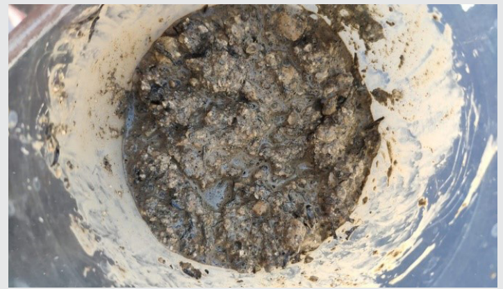
Figura 8. Mezcla uniforme ya con el agregado de agua.
