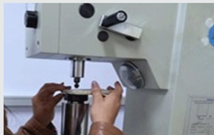
Figura 9. Medición de Dureza en el laboratorio de Metrología Fuente propia de la investigación, 2018
