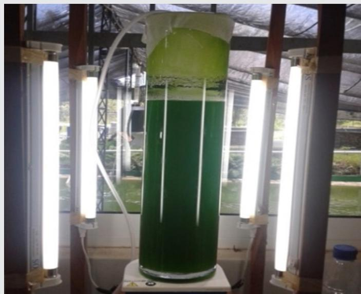
Figura 2: Fotobiorreactor para el cultivo de microalgas.
