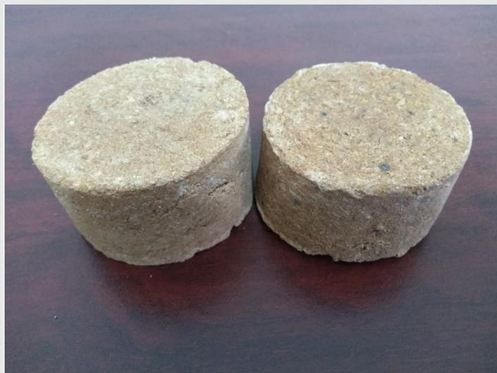
Figura 4. Briquetas enriquecidas de aserrín sin microalgas (izquierda) y con biomasa de microalgas (derecha).
