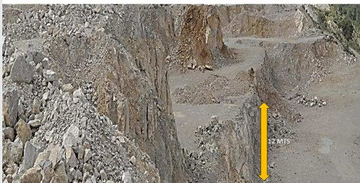
Figura 4. Banco secundario de extracción de piedra caliza. Tomado del recorrido realizado en la mina de la empresa Tenex-tepec y sus Anexos.
