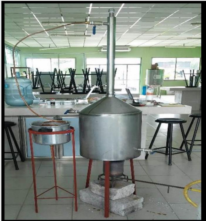
Figura 2. Equipo de destilación en el producto de la bebida alcohólica no tradicional de malanga.
