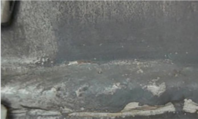
Figura 3. Entalla en el borde del cordón de soldadura de la probeta para fatiga.
