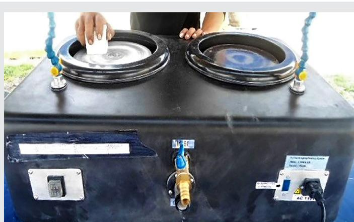
Figura 2. Lijado y pulido de las probetas.
