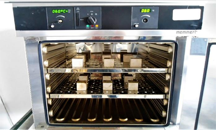
Figura 4. Secado de las 12 probetas.
