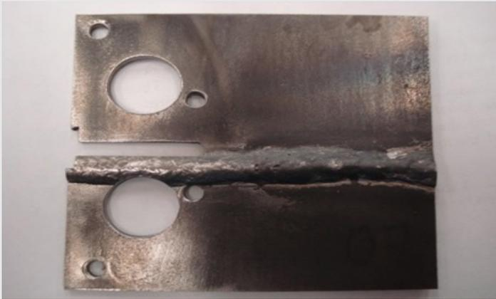
Figura 4. Probeta para pruebas de fatiga con cordón de soldadura.
