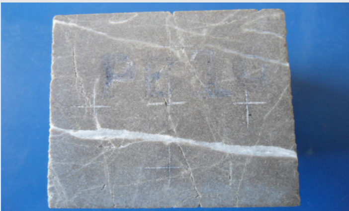
Figura 12. Fotografía de una probeta con grietas.
