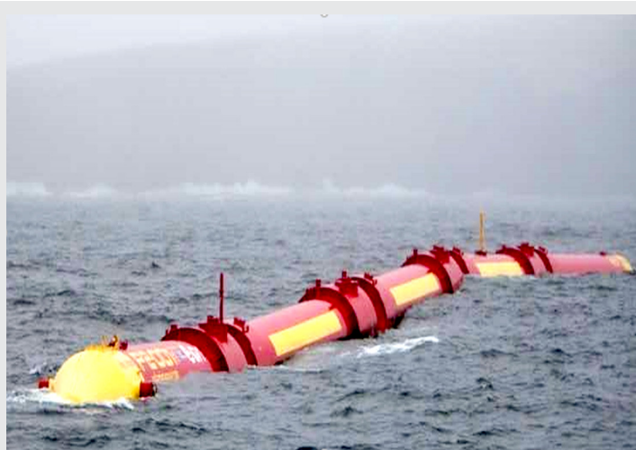
Figura 7. Generador eléctrico flotante Pelamis.
