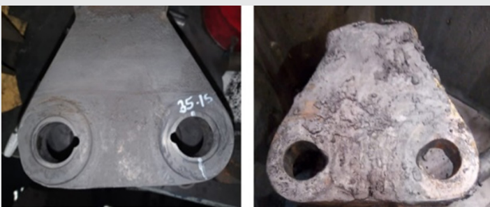
Figura 3. Sillas deformadas en el área del eje.
